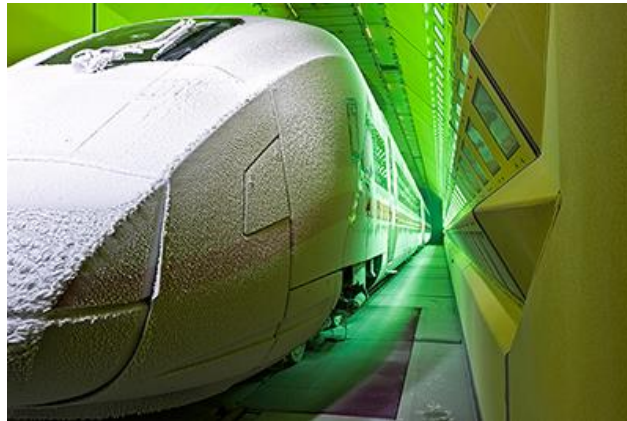
Abbildung 1: ICE 4 im Klima-Windkanal des RTA in Wien
